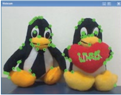
Figura 2 A técnica de detecção de cantos permite encontrar diferenças entre duas imagens.
