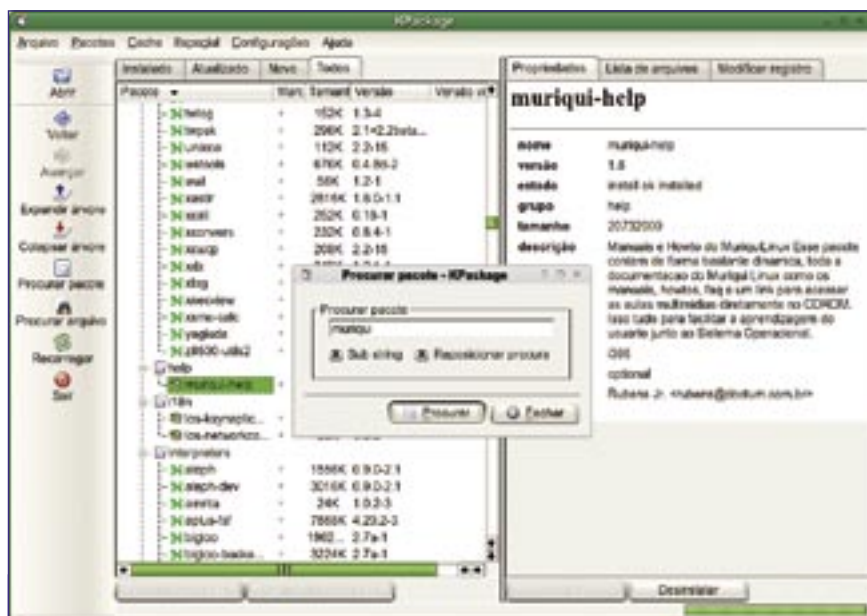
Figura 1: O KPackage pode ser usado na administração dos pacotes. A distribuição é compatível com o repositório stable do Debian .
