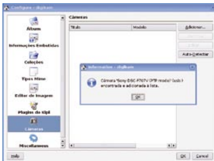
Figura 2: Testamos três modelos de câmeras digitais das marcas Sony, HP e Kodak. Todas foram reconhecidas automaticamente pelo digiKam . É bom ressaltar que as câmeras devem estar no modo PTP , ou seja, configuradas para serem identificadas como câmeras digitais e não como disco externo.
