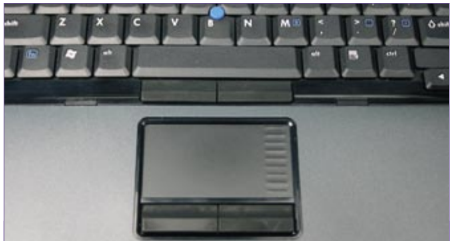
Figura 2: A HP equipou o NC4200 com um trackpoint e um trackpad , dando aos usuários possibilidade de escolha entre os substitutos do mouse mais populares. A área ondulada à direita do trackpad funciona como roda de rolagem e terceiro botão do mouse.
