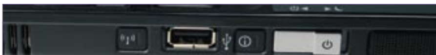
Figura 1: O botão com o símbolo da antena à esquerda do conector USB liga e desliga as interfaces WLAN e Bluetooth sem reiniciar o sistema. O botão Info entre o botão de força e o conector USB produz um Scan Code e, por padrão, chama a ajuda do Gnome .
