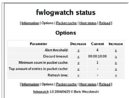
Figura 5: Os administradores podem usar o navegador para configurar o fwlogwatch. O Alert Threshold (Limiar de Alerta) especifica o número de mensagens necessárias para disparar uma contramedida.
