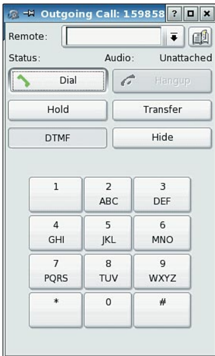
Figura 5: Com o KPhone, nem mesmo os iniciantes podem cometer erros. Tons DTMF podem ser produzidos com um clique e usados para consultar uma secretária eletrônica.
