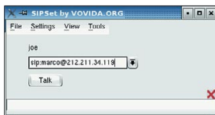
Figura 6: A interface gráfica do SIPset não confunde o usuário: digite um endereço, clique no botão Talk e fale.
